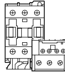
s. 38 CTX 3 güç kontaktörleri, RTX 3 termik röleler
